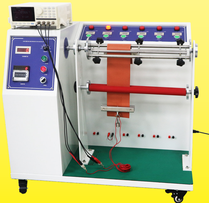
弯曲试验中的柔性硅胶加热器
